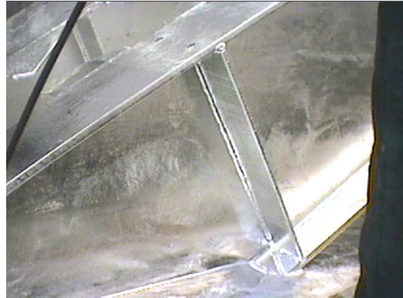
1.-2. ábra: Bemerítés a horganyolvadékba (hő kamerás felvétel és hagyományos kép)
