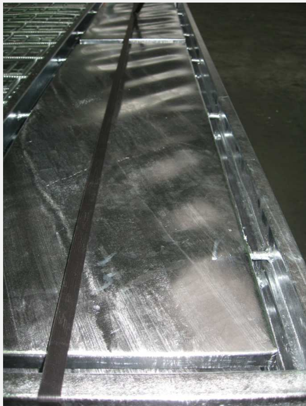
Nagyfelületű, vékony lemezekből összeállított szerkezet merevítés nélkül hibához vezet
