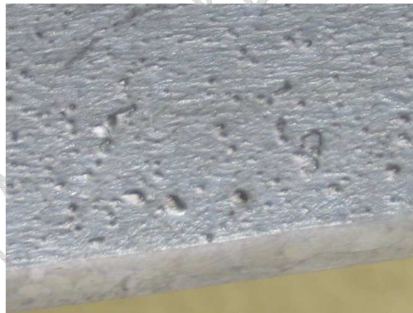
6. ábra: A hengerlés felületi hibái bevonás után
