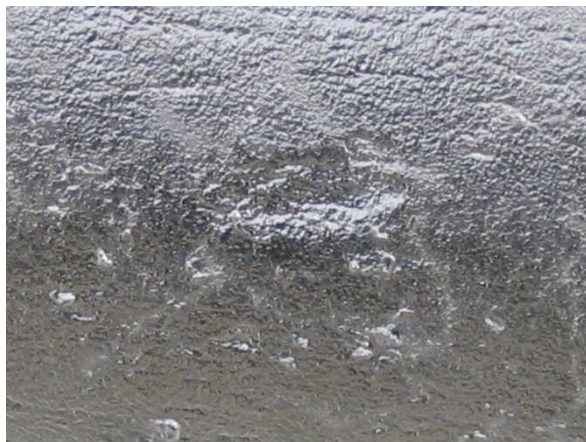
5. ábra: Mély revenyom a horganyzott felületen
