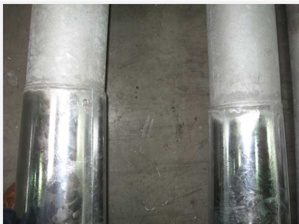
Reaktív (szürke) és optimális acélminőségek összehegesztve
