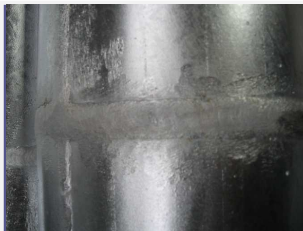
A hegesztő huzal szilícium és foszfor tartalma a varrat bevonatát befolyásolja
