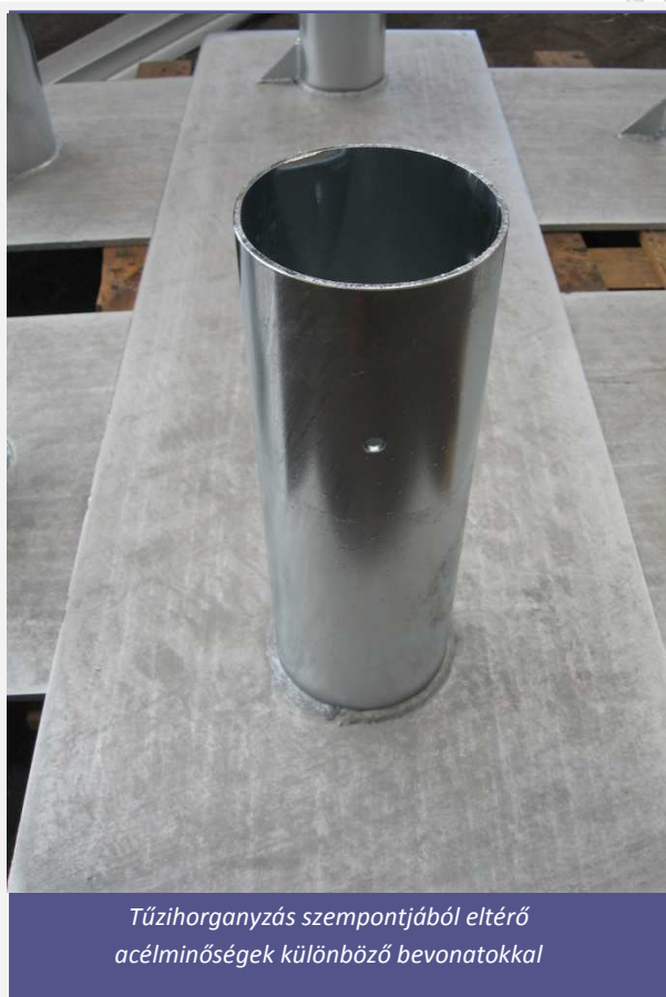
Reaktív (szürke) és optimális acélminőségek összehegesztve
