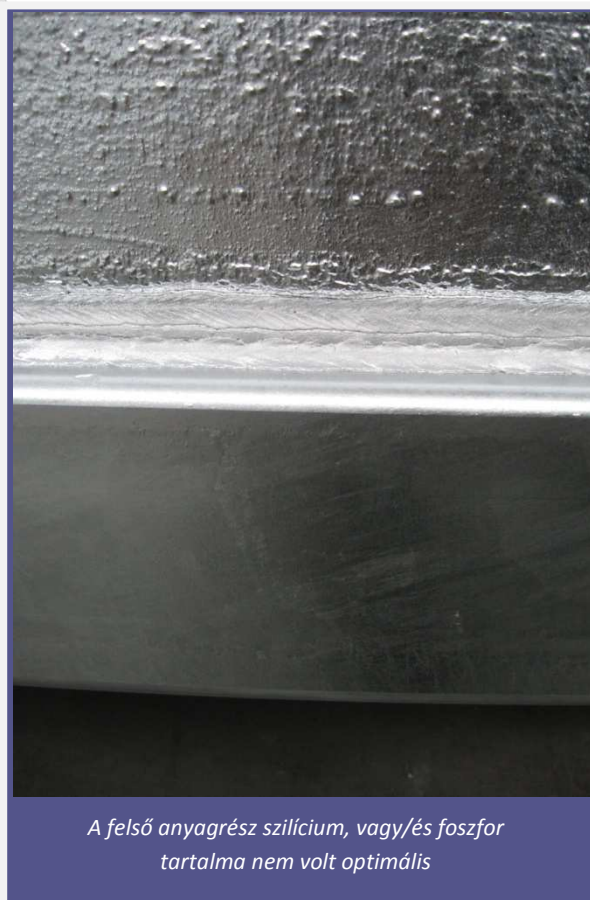
A hegesztő huzal szilícium és foszfor tartalma a varrat bevonatát befolyásolja
