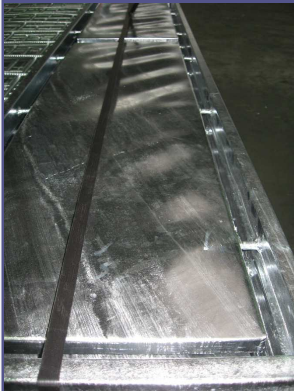
Merevítés nélküli lemezfelületek keretbe hegesztése okozta hullámosodás
