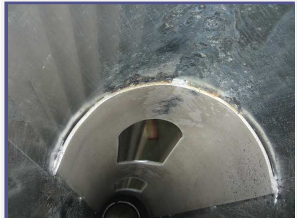
Az átlapolt felületek salakfeltapadáshoz, korróziós góckhoz vezetnek
