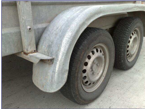
12. ábra: Horganyzott lemezből készített mélyhúzott sárvédő lemez
