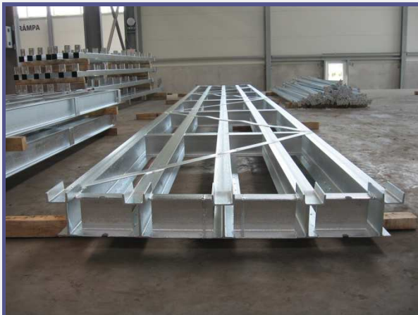
Túl nagy vastagságkülönségű acéllemezek összehegesztése utáni deformáció
