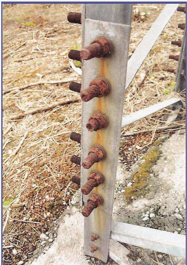
A galvanizált csavarokról az évek alatt gyorsan lepusztult a horgany
